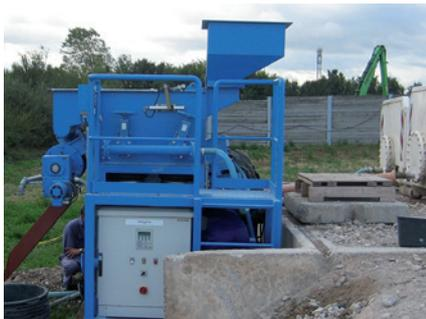
Abbildung 5: Setzmaschine an Recyclinganlage
