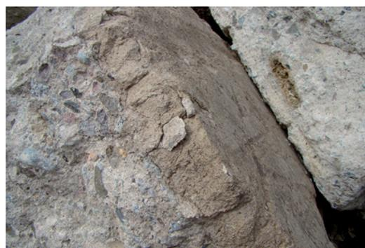
Abbildung 4: Estrichschicht auf Betonuntergrund
